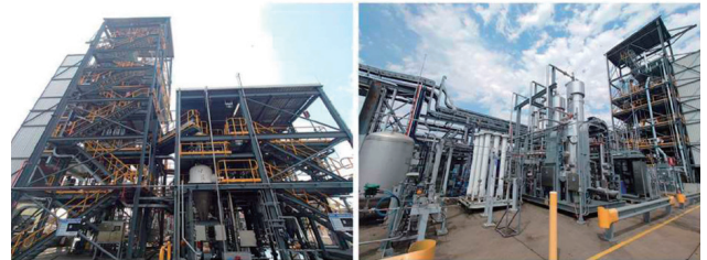
図3 HESCでの褐炭由来の水素製造見学の様子 （左図）褐炭ガス化装置（右図）水素高純度化装置
